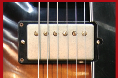
当時のES-175には、P-90に変わりギブソンが1957年に発表した「PAF」と呼ばれるハムバッキング・ピックアップが搭載されていた。プロトタイプには、音色の再現に最も適している現行のハムバッキング・ピックアップ「57 Classic」を使っている。
